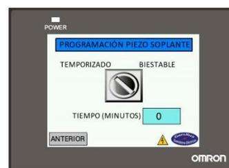
SUBMENU DE UNA BOMBA SOPLANTE PARA PROGRAMAR CONFIGURACIÓN DEL PIEZOELÉCTRICO Y TIEMPO DE FUNCIONAMIENTO.
