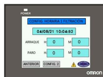
SUBMENU DE LA FILTRACIÓN PARA REALIZAR PROGRAMACIÓN HORARIA MEDIANTE RELOJ.
