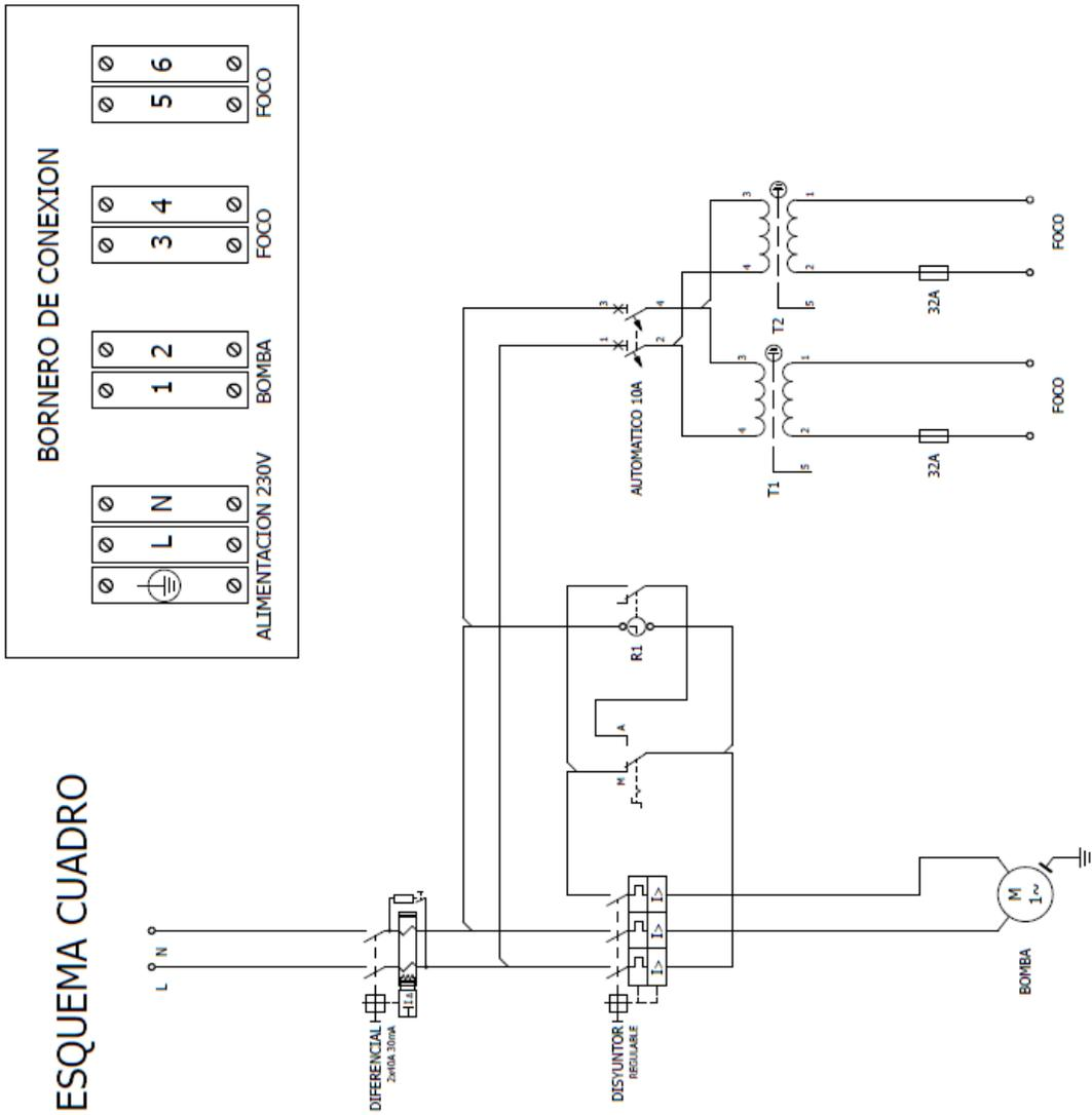
**NOTA:** Antes de poner en marcha la bomba debe regular la intensidad del disyuntor con arreglo a la placa de características de la bomba
